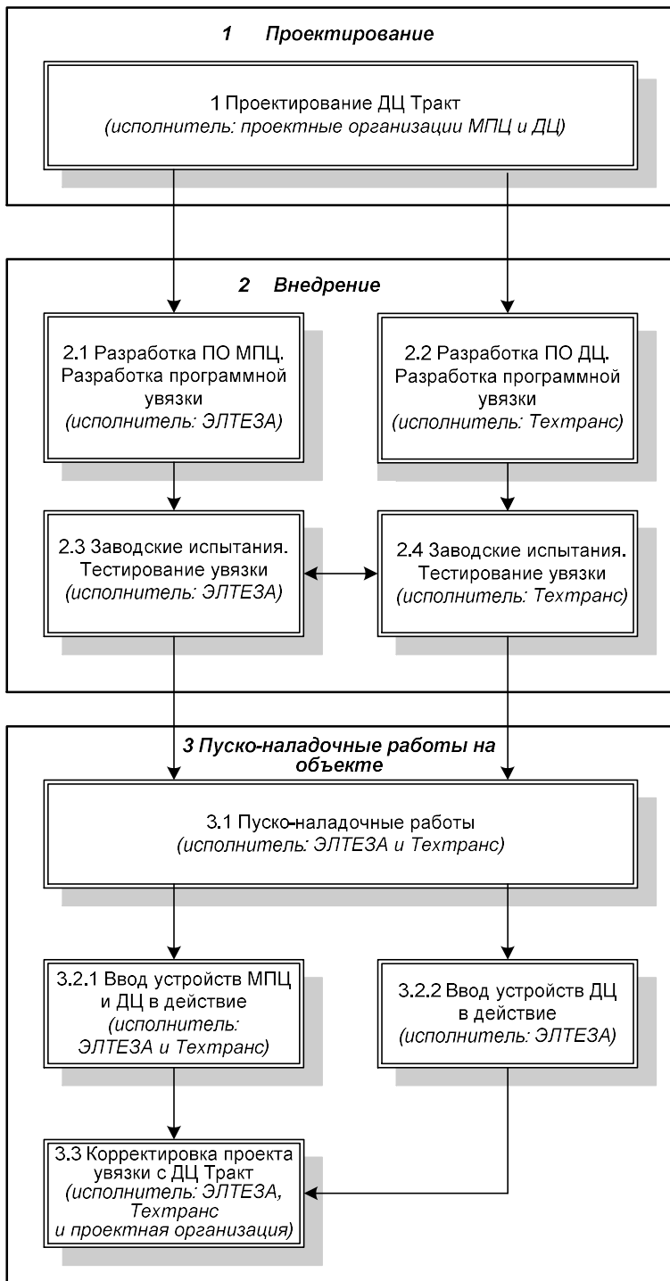
Рисунок 8.1 Выполнение комплекса работ внедрения МПЦ и ДЦ.
