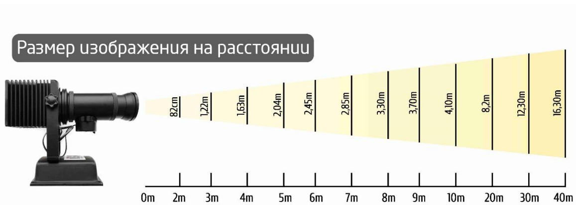
Рис.17 Зависимость размера изображения от расстояния проецирования
