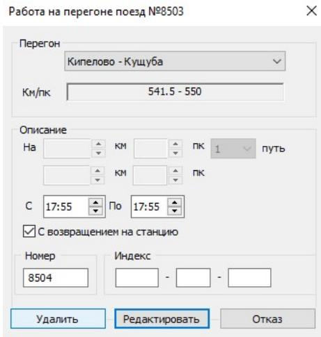
Рис.245. Окно, позволяющее отредактировать работу на перегоне.
