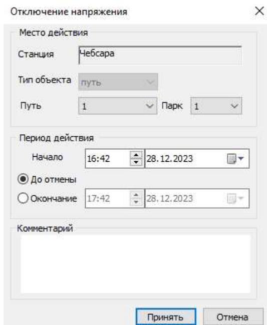
Рис.215. Окно для ввода отключения напряжения на станции.
