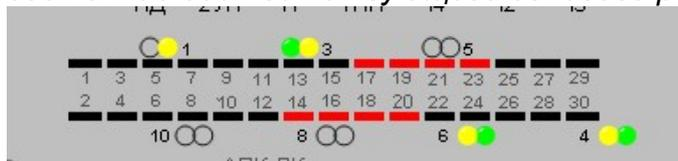
Рис.296. Схематичное изображение перегона между станциями на мнемосхеме
