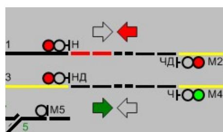
Рис.295. Индикация указателя направления автоблокировки на мнемосхеме участка
