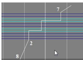
Рис.91. Нить, имеющая стоянку на нескольких путях станции.
