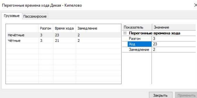
Рис.280. Корректировка времени хода для нечетных грузовых поездов.
