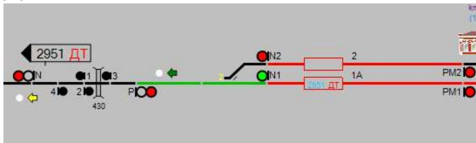
Рис.311. На перегоне ожидается поезд 2951, для которого готов маршрут отправления.
