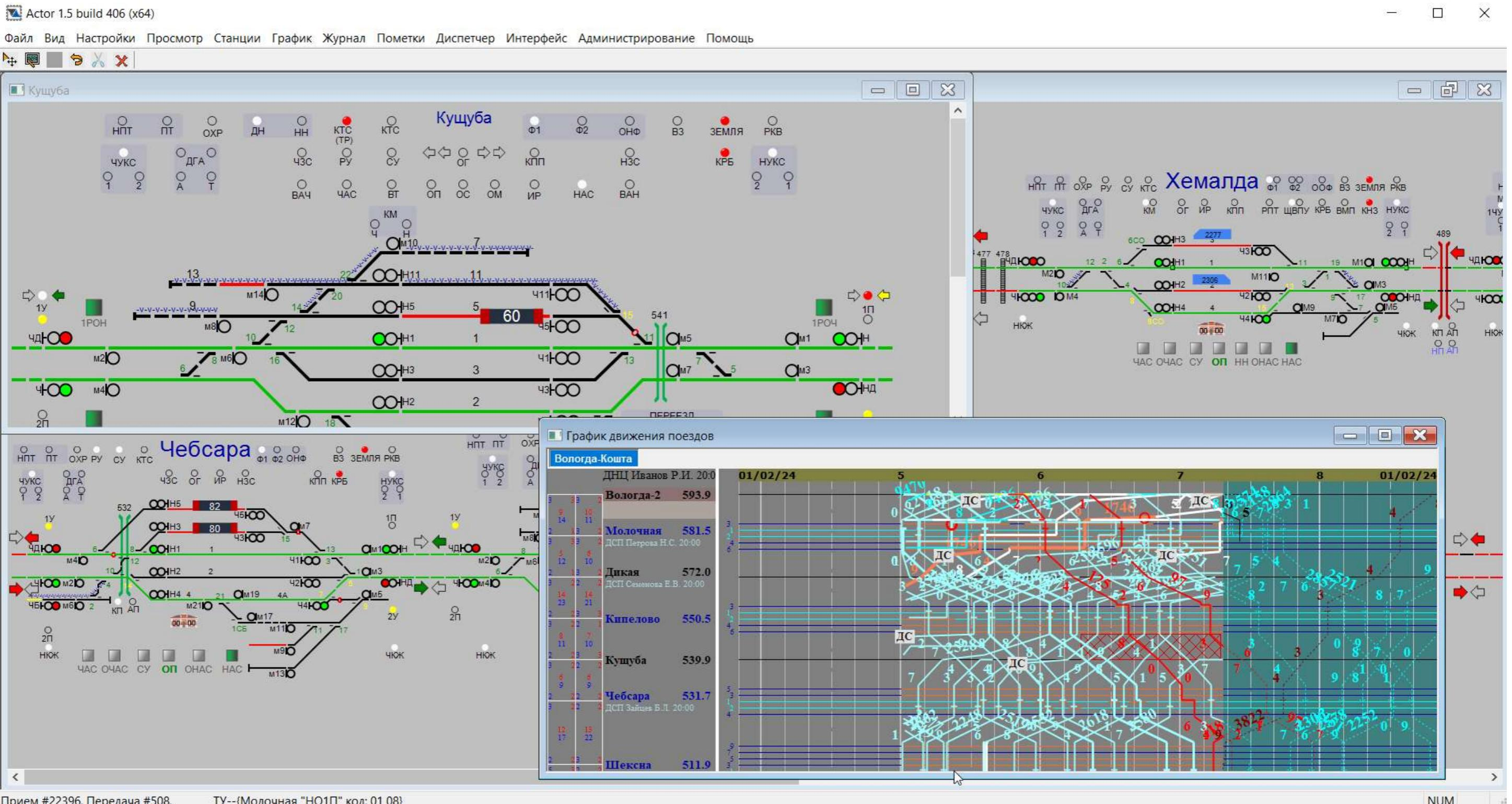
Рис.6. Одновременное размещение на экране поля ГИД и поля Табло.
