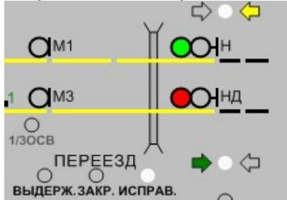
Рис.293. Изображение переезда на мнемосхеме станции
