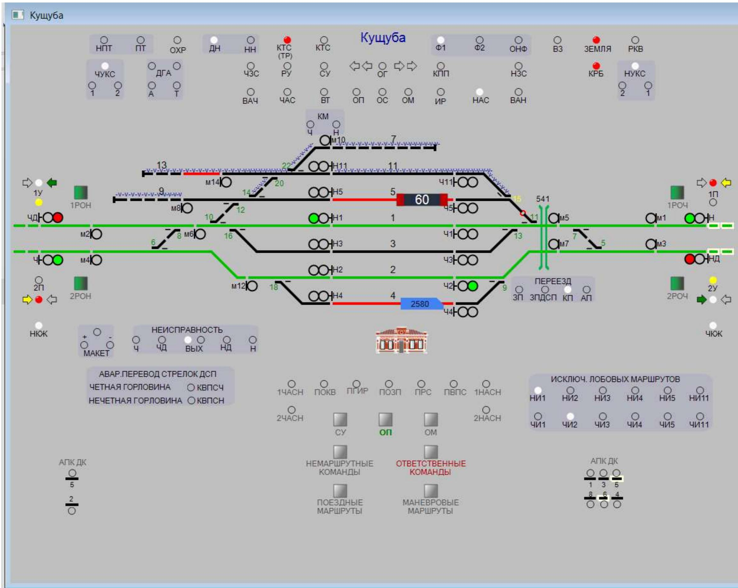
Рис.4. Вид поля Табло. Схема станции
