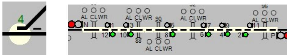
Рис. 333. Примеры обводки стрелки и перегона, на которых установлены предупреждения.
