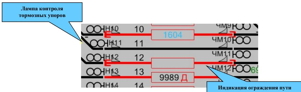
Рис.292. Лампы контроля тормозных упоров
