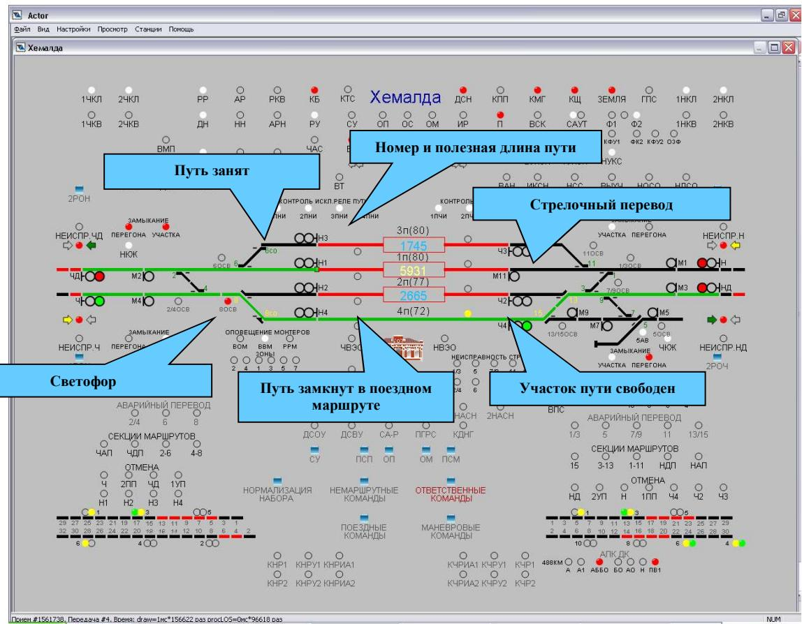
Рис.291. Графические элементы мнемосхемы
